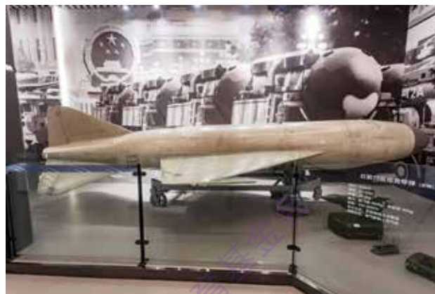
上游一号舰舰导弹: 弹长: 6.55 m; 弹径: 0.76 m; 翼展: 2.41 m; 弹重: 2 095 kg Противокорабельная ракета-1: длина 6,55 м; диаметр 0,76 м; размах крыла: 2,41 м; масса: 2095 кг
